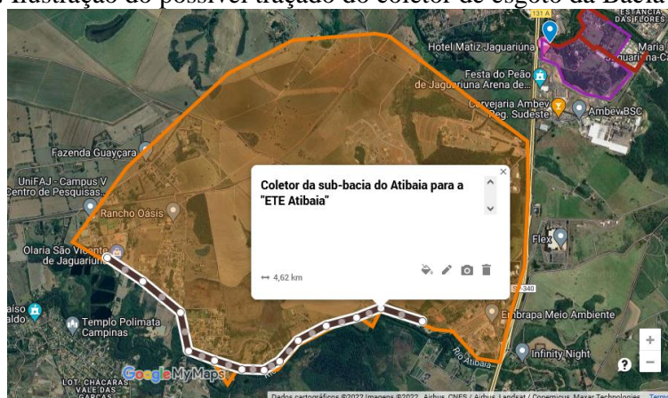
Figura 6: Ilustração do possível traçado do coletor de esgoto da Bacia do Atibaia.
