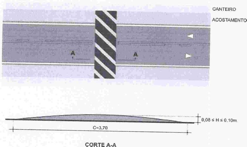
3.10.2 – Ondulação Transversal Tipo B: Instalada quando há a necessidade de limitar a velocidade máxima da via para 20 km/h em vias urbanas locais que não circulem linhas regulares de transporte coletivo e não seja possível implantar a Ondulação Transversal Tipo A. Sua execução inclui locação,
