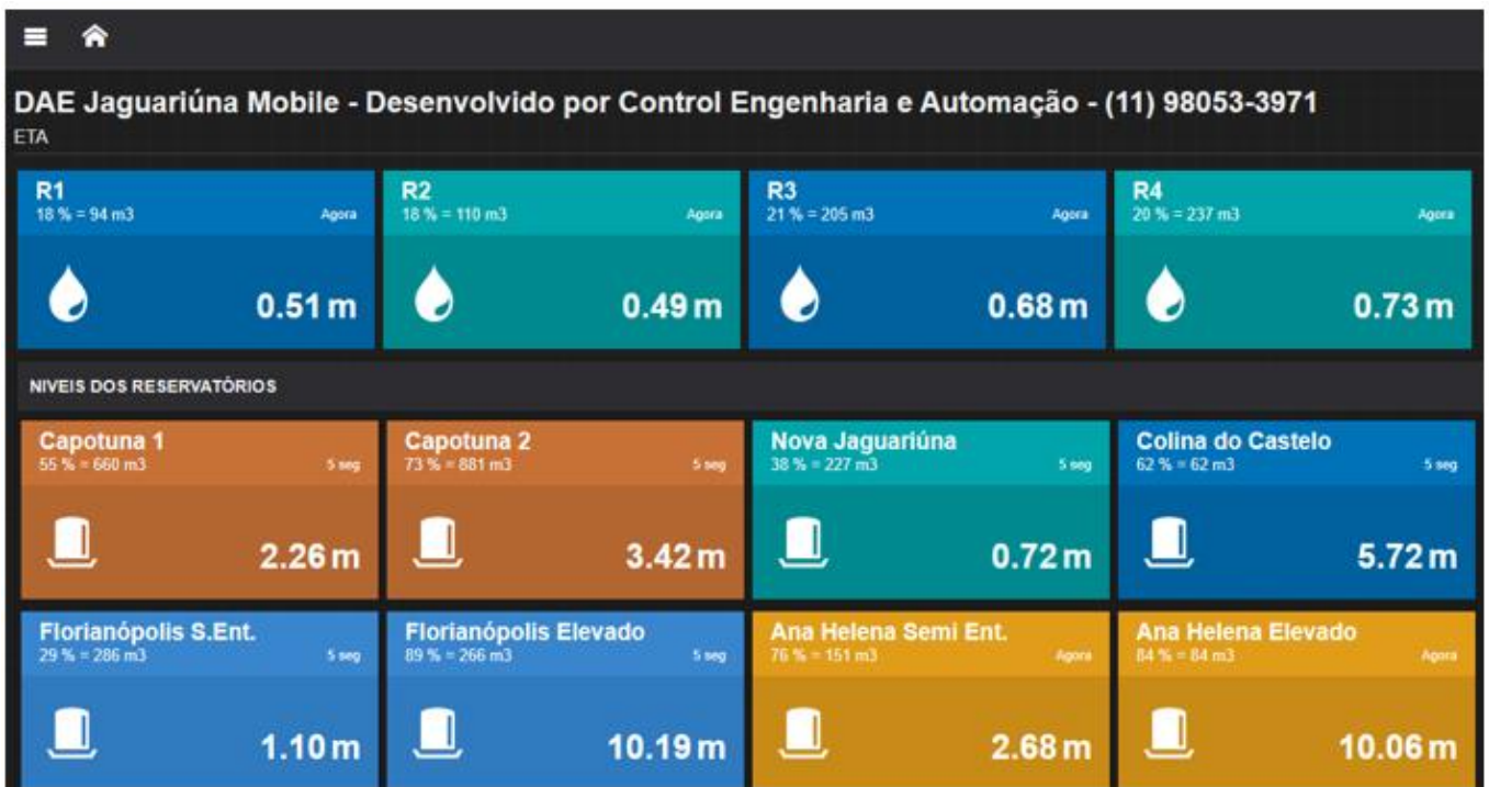
Figura 1 (Menu de Operações do Supervisório – Versão Mobile)
